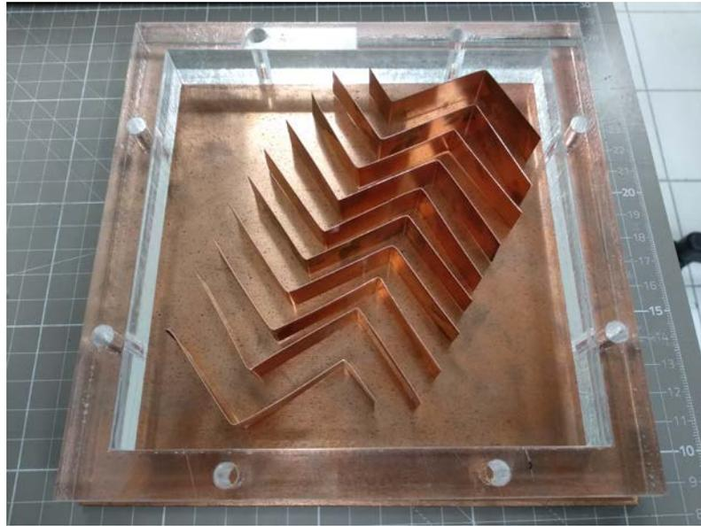
8. Procedere con la saldatura delle lamelle. Questa è forse la procedura più difficile dell'intera costruzione. Per saldare le lamelle si suggerisce di posare la lastra di rame su un fornello elettrico e scaldando il tutto andare a fondere il filo di stagno lungo il bordo della lamella che appoggia sulla lastra di rame.
