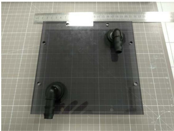
10. Posizionare un filo di silicone lungo il bordo del fondo e del lato del dissipatore, aiutandosi con le barre filettate. Infine posizionare i 3 strati uno sull'altro e stringere i dadi.
