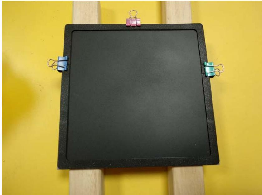
5. Incollare l'acrilico sopra alla guarnizione utilizzando il cianoacrilato. Otteniamo in questo modo un pozzetto da dove l'alcool liquido non può scappare.
