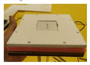
Stendere uno strato di pasta termoconduttiva sopra alla cella di Peltier.
